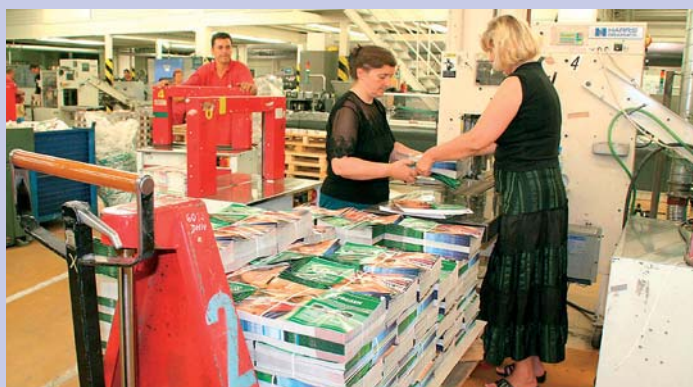
V knihárně se zkompletuje obálka s vnitřními bloky stránek a hotové výtisky se připraví na palety k přepravě z Břeclavi do Prahy
