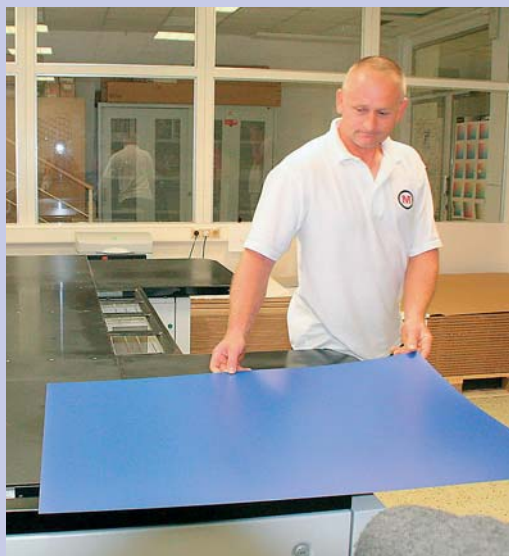
Hliníková deska, na níž se vypálí data pro tisk
