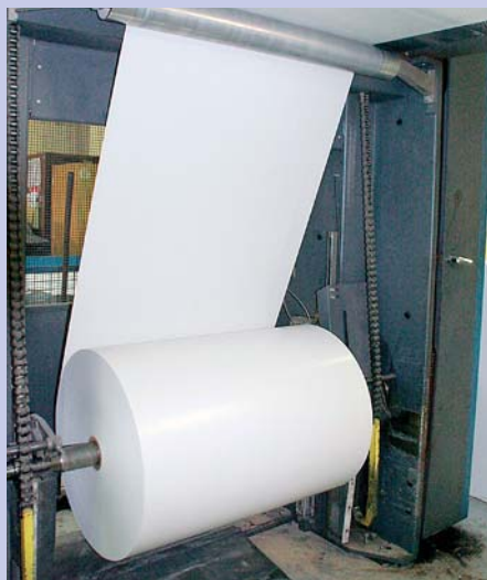
Role papíru o šířce 860 mm zahraniční výroby, připravená pro rotační tisk
