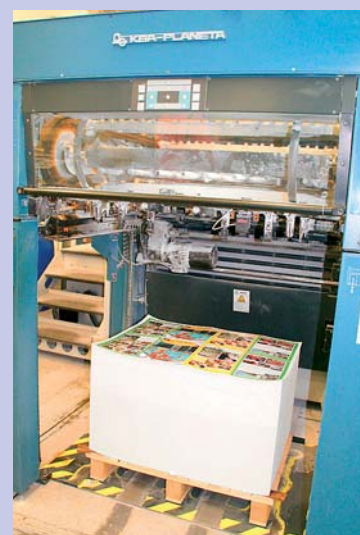
Vytištěné obálky zářijového čísla. Obálka se tiskne plochým tiskem na tiskařském stroji KBA RAPIDA 105
