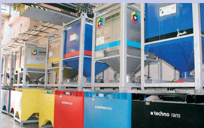
Tiskne se ze čtyř barev, které jsou uloženy v obřích kontejnerech (modrá, červená, žlutá, černá)
