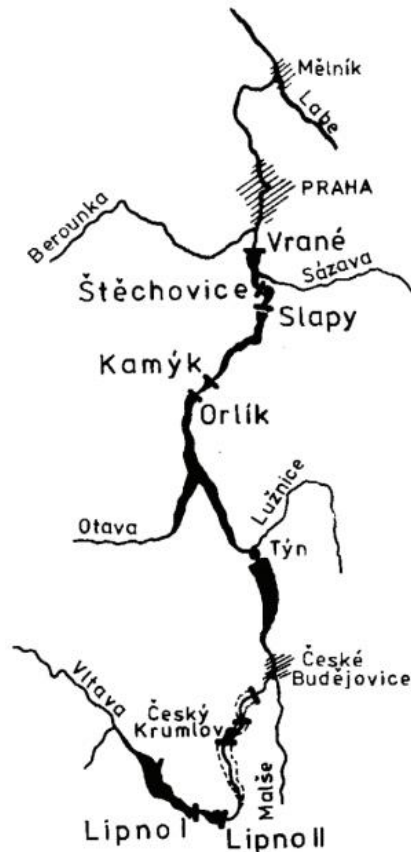
Obrázek 38 Schéma vltavské kaskády vodních elektráren
