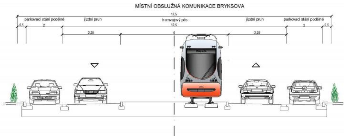
Obrázek 45 Příčný řez ul. Bryksova – dlouhodobý návrh
