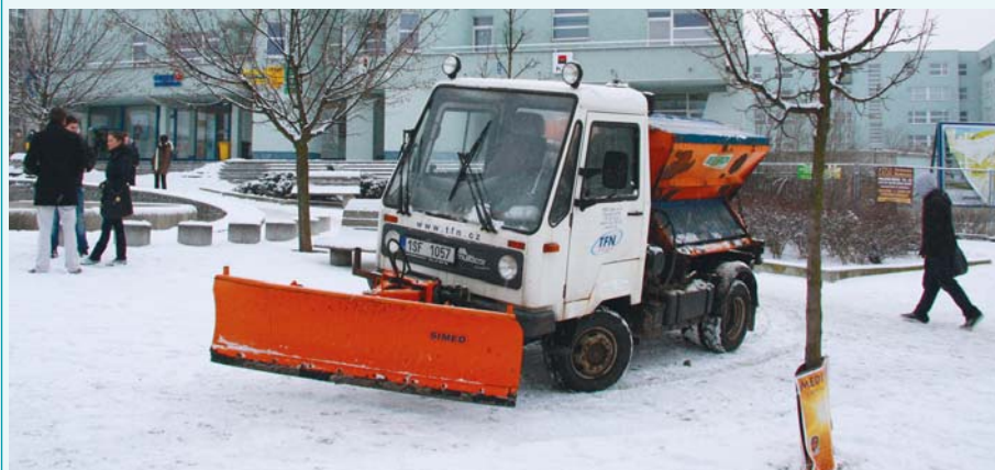
V případě náledí se zásah kvůli schůdnosti chodníků doplňuje posypovým materiálem z vozidla Multicar s radlicí, které patří Odboru hospodářské správy ÚMČ Praha 14.
