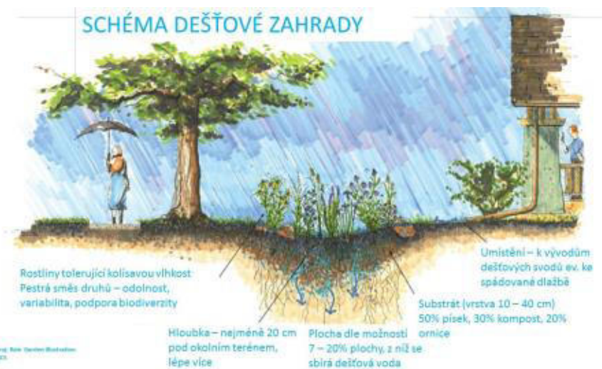
Schéma dešťové zahrady ( https://zena.aktualne.cz/schema-destove-zahrady/r~9782cbfee84f11e698c20025900fea04/ )
