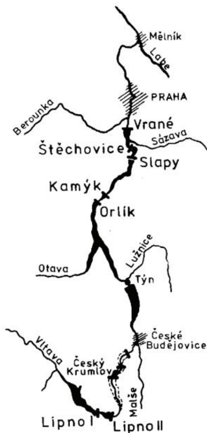
Obrázek 38 Schéma vltavské kaskády vodních elektráren
